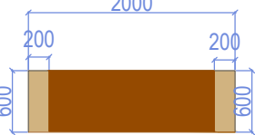
šablóna pre vytýčenie parkovej typovej lavičky v malom zálive
